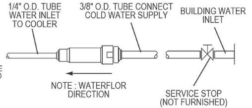
PUSHING TUBE IN BEFORE PULLING IT OUT HELPS TO RELEASE TUBE
