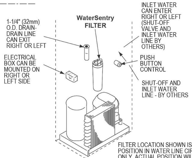
FILTER LOCATION SHOWN IS FOR POSITION IN WATER LINE CIRCUIT ONLY. ACTUAL POSITION WILL BE WHERE MOUNTING BRACKET IS FASTENED IN MOUNTING BOX.
