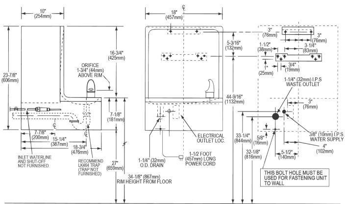
NOTE: INSURE PROPER VENTILATION BY MAINTAINING 6" (152MM) CLEARANCE FROM CABINET LOUVERS TO WALL ON EACH SIDE OF COOLER
